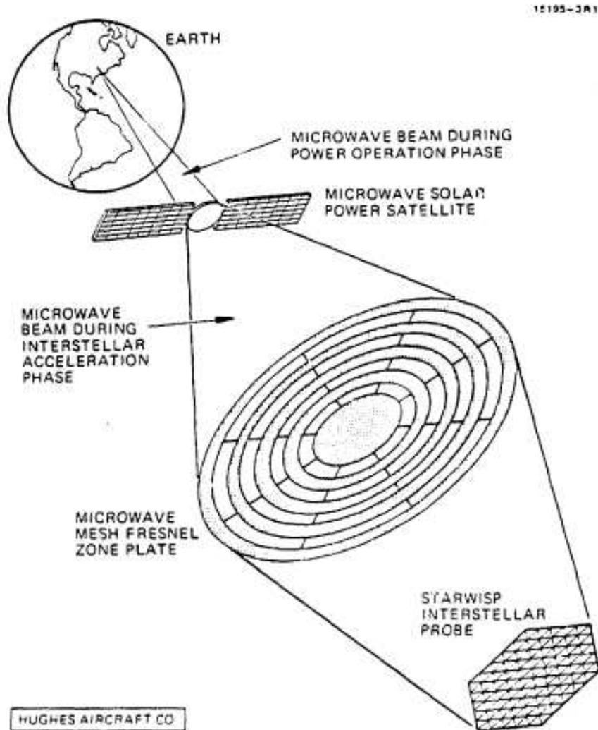
Figure A-1. Starwisp: A Maser-Pushed Interstellar Probe.
